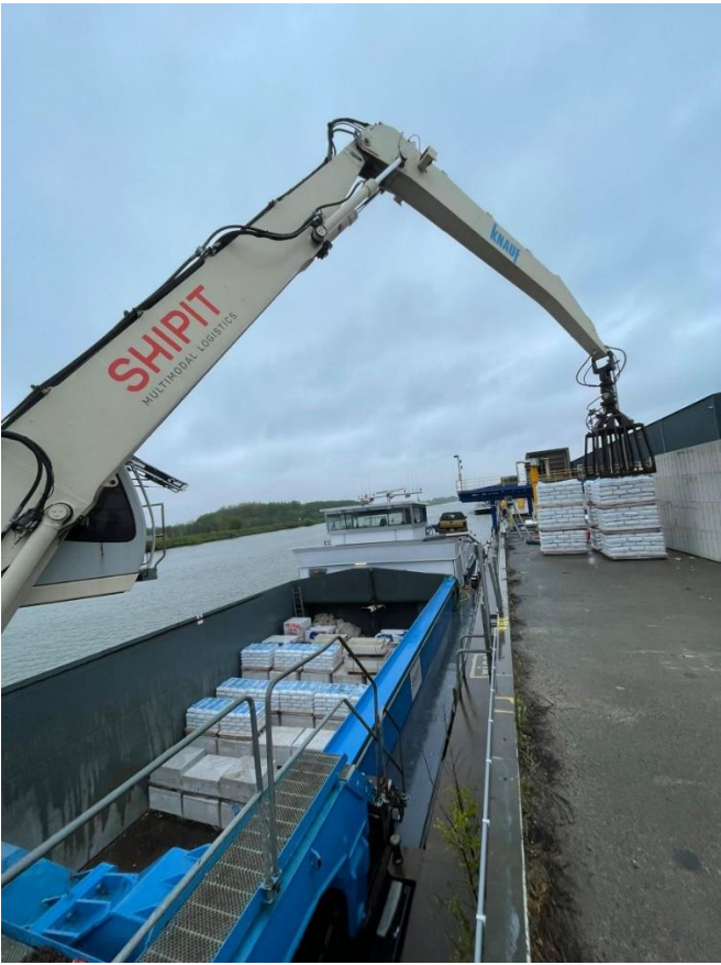
©Shipit - Lossen van kalksteenblokken bestemd voor een Brusselse bouwplaats
