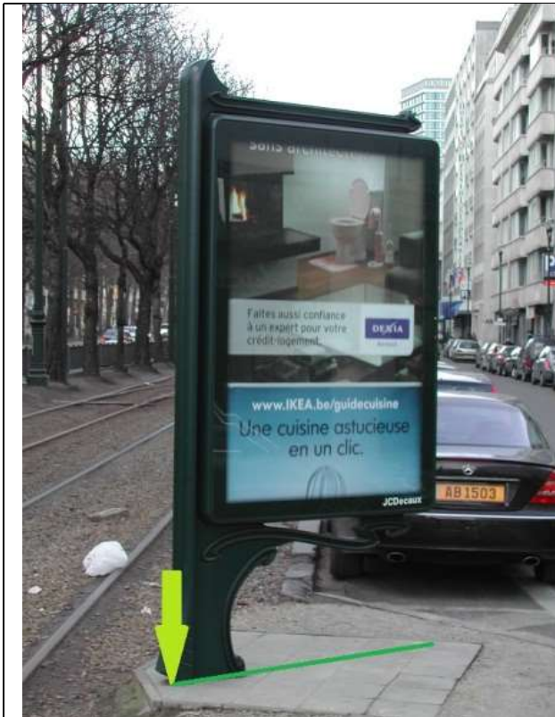
De planimeters waarvan de afmetingen kleiner zijn dan of gelijk aan 1,2 m worden aan de voet van één van de zijden (groene pijl) opgenomen en voorgesteld in de laag « CR36P » door middel van het georiënteerde symbool « CR3602P » (oriëntatie aangegeven door de groene lijn).
