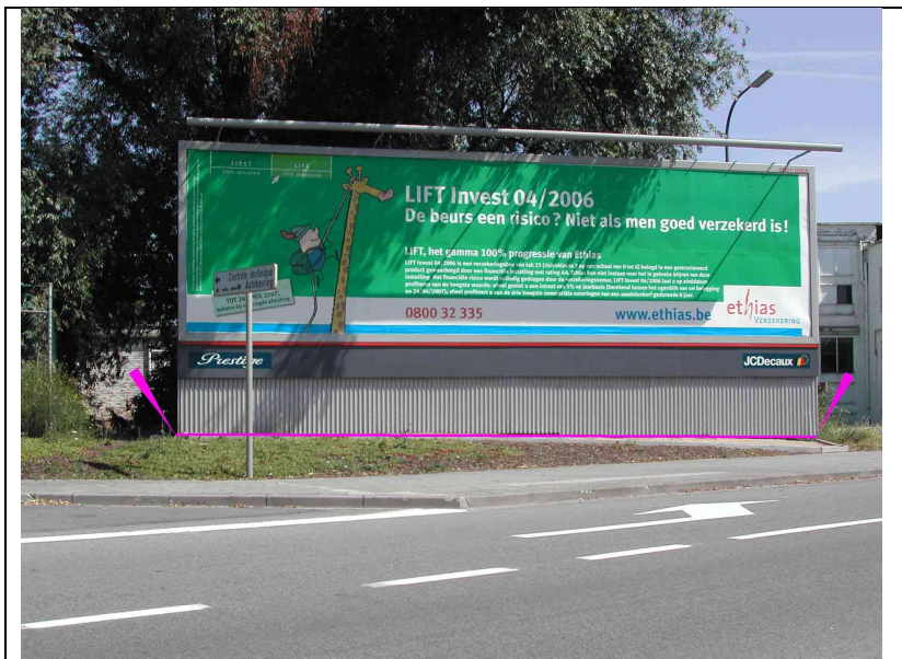
Van de reclameborden waarvan de afmetingen groter zijn dan 1,2 m wordt de totale ingenomen grondoppervlakte opgenomen. Zij worden voorgesteld in de laag « CR36L » door middel van lijnelementen.
