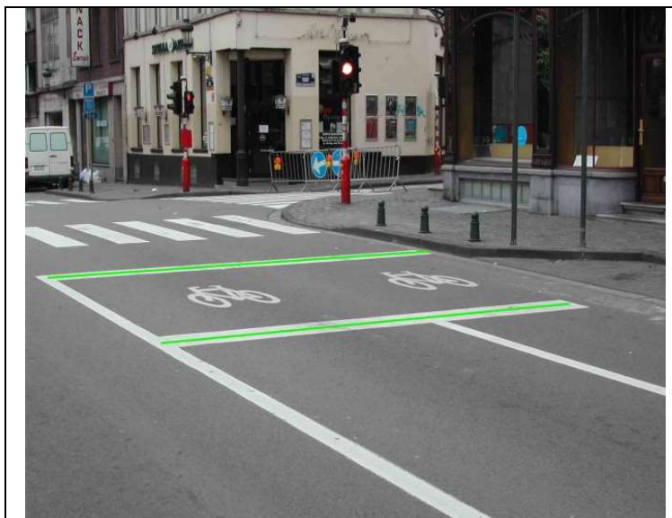
Stopstrepen en afbakeningsstrepen van een opstelstrook voor fietsers: « CR2302L ».
