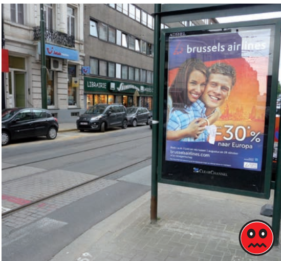
Niet-conform reclamebord (geen horizontale stijl op ten hoogste 30 cm boven de grond), dat een voetganger die wil oversteken aan het zicht onttrekt.
