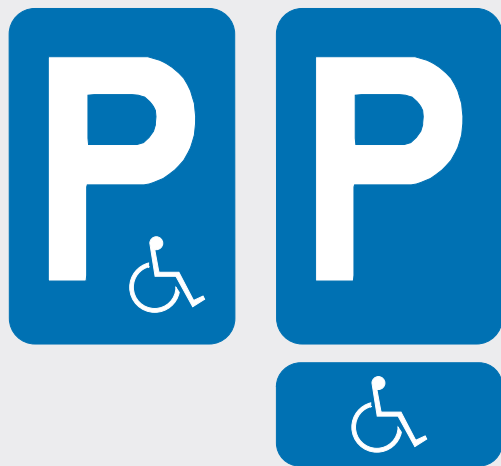
Conforme aanduidingen van parkeerplaatsen voor personen met een handicap.
