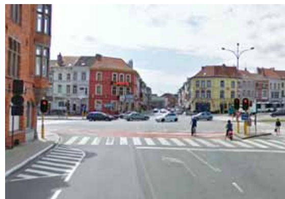
Fig. 5.41. et fig. 5.42. Indirect linksaf met specifiek verkeerslicht voor fietsers te Gent (Citadellaan).
