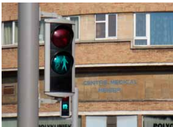
Fig. 5.26. De gedeelde lens fietser-voetganger – getest op twee Brusselse oversteekplaatsen – moet wachten op een aanpassing van de wegcode alvorens op grote schaal toegepast te kunnen worden.
