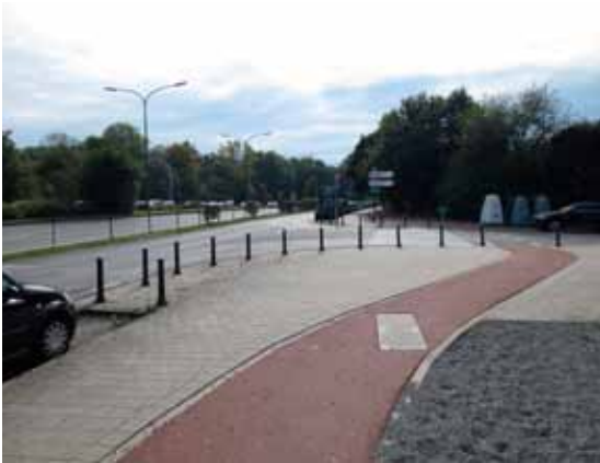
Fig. 4.9. Bij een ventweg langs een grote laan kan het volledige kruispunt verhoogd aangelegd worden als plateau (Woluwelaan x Pierre De Cockstraat). In dit voorbeeld is de - weliswaar zachte - uitbuiging niet nodig.
