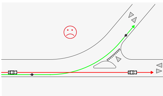
Fig. 4.18.a. De afgebeelde situatie zet de bestuurders niet aan om hun intenties duidelijk te maken. De fietser die zijn weg vervolgt op de weg die naar links afbuigt, snijdt het traject van de bestuurder die rechts wil afslaan (recht-door rijden binnen dit wegverloop).
