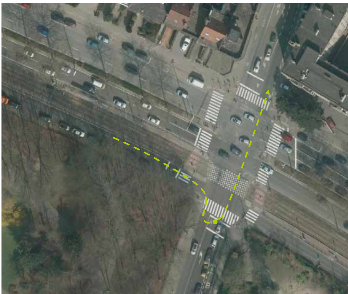
Fig. 5.22. De fietser die op de ventweg van de Lambermontlaan rijdt en linksaf wil slaan heeft er voor zijn veiligheid belang bij zich bij groen op te stellen in de FOS aan zijn rechterzijde.
