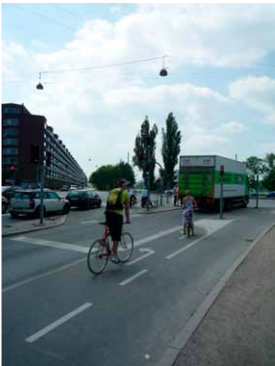
Fig. 5.52. Op dit kruispunt in Kopenhagen is het oversteken door fietsers van het recht afslaand verkeer zodanig geregeld dat de fietsers die rechtdoor gaan of links afslaan geen groenfase verliezen. Rood voor fietsers aan het vooruit geplaatste verkeerslicht.
