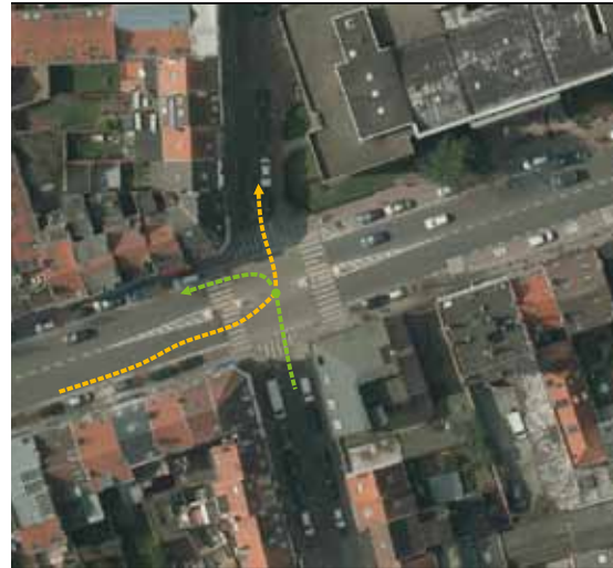
Fig. 4.13. Een middeneiland voor een voetgangersoversteekplaats in 2 fasen zorgt tevens voor comfort en bescherming aan fietsers die aan het wachten zijn om links af te slaan op het kruispunt (Oudergemselaan). Bron:
