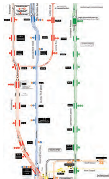
Plan de voies dans le sous-sol de Manhattan. On y voit les lignes à 4 voies pour les services express
