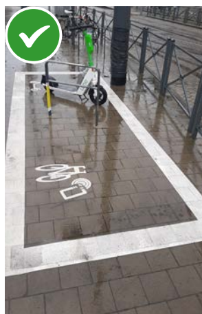
La dropzone doit être signalée par une case entière avec à l'intérieur le pictogramme
