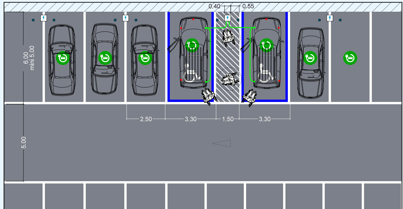
Inrichting 1A buiten openbare weg dubbele parkeerplaats voorwaarts parkeren (uitgerust met een standaard laadpaal op een voet)
