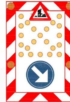
Figure F3-19 : Dispositif cadre avec flèche lumineuse de rabattement
