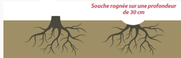
Figuur F3-26 : Gefreesde stronk tot op een diepte van 30 cm onder maaiveld
